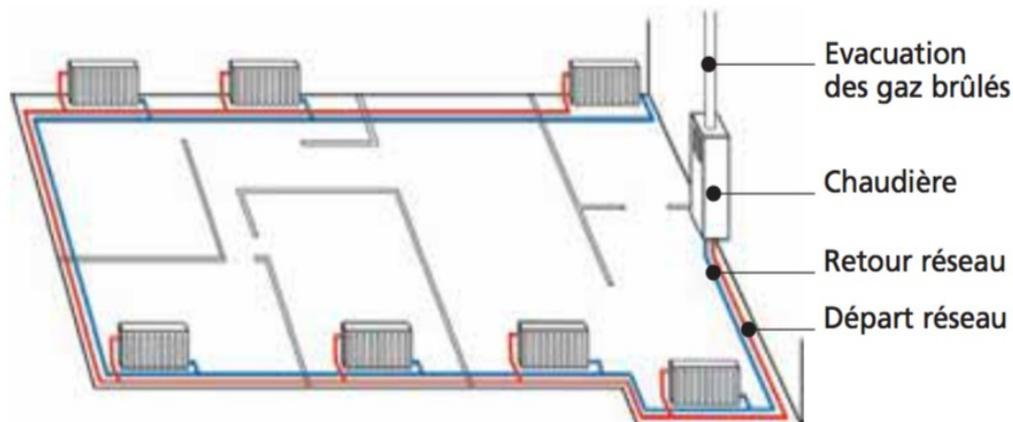
**Principe du chauffage central**
