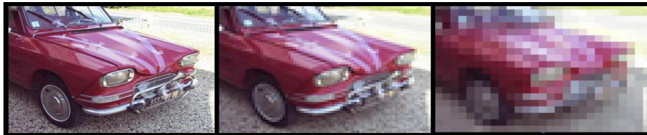
Fig.4 : Image matricielle avec une résolution de moins en moins importante
