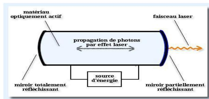
*Fig.3 Schéma de principe d'un laser.*
